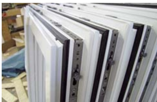
Die Beschläge müssen einen besonderen Korrosionsschutz aufweisen
